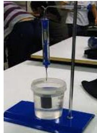
Possiamo vedere che il volume del liquido spostato dall'immersione del cilindretto è uguale.
